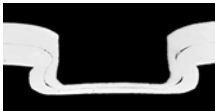
Figuras 87 e 88 - Junta Clinching. Fonte: TWI Ltd.
