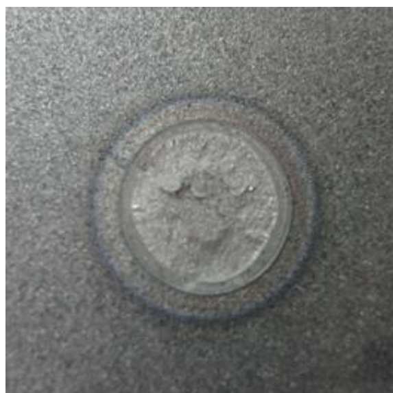
Figura 66 – Falha de interface Fonte: TWI
