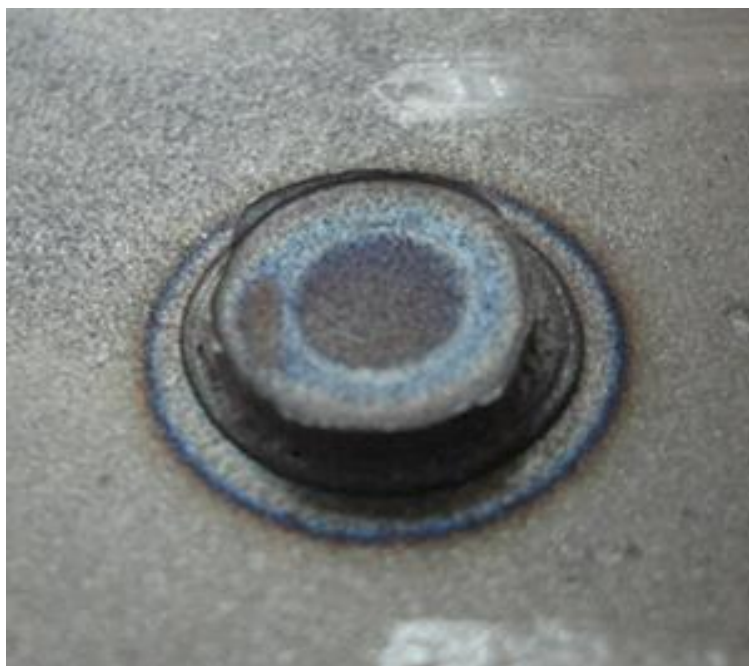
Figura 64 – Falha plug. Fonte: TWI
