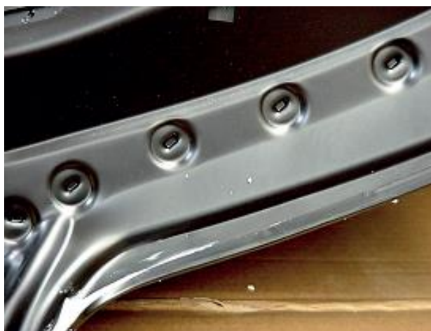
Figuras 87 e 88 - Junta Clinching. Fonte: TWI Ltd.
