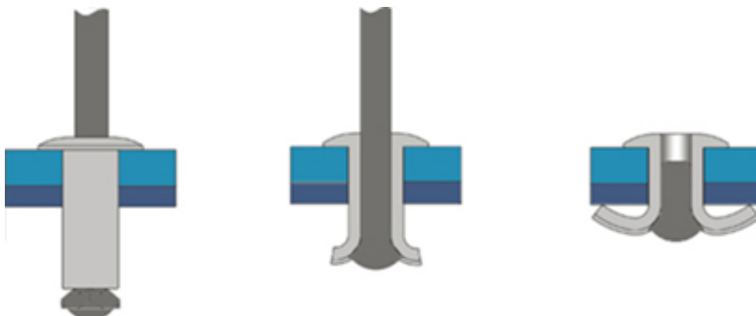
Figura 104 – Passos da rebitagem cega. Fonte: TWI
