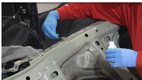
Figura 126 – Aplicação de tratamento de superfície. Fonte: CESVISMAP
