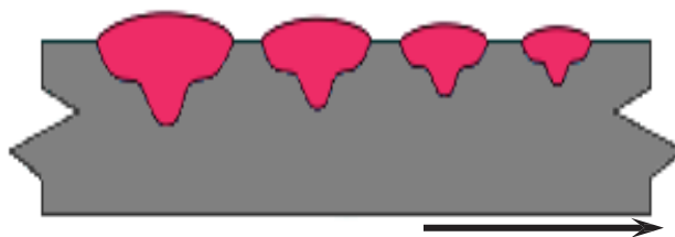
Figura 31 – Efeito do aumento de velocidade. Fonte: TWI
