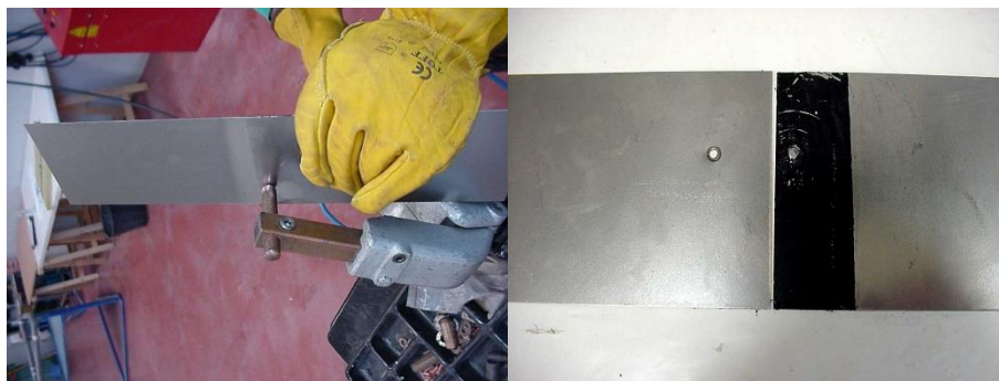
Figura 82 - Ensaio das características do local, submetendo-o a uma força de cisalhamento até a rutura. Fonte: CESVIMAP
