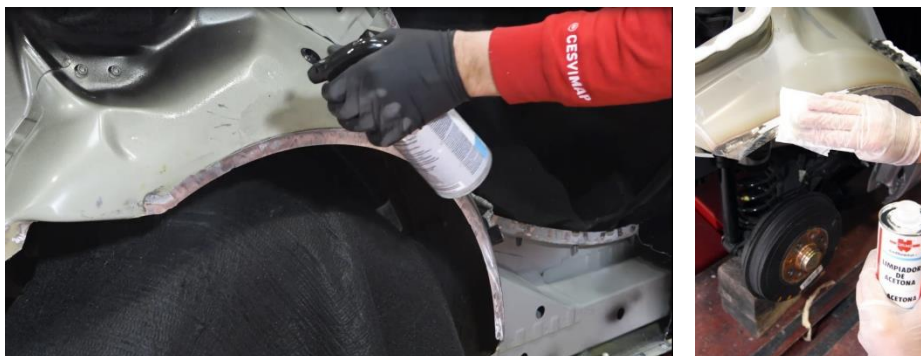
Figura 125 – Desengorduramento. Fonte: CESVISMAP
