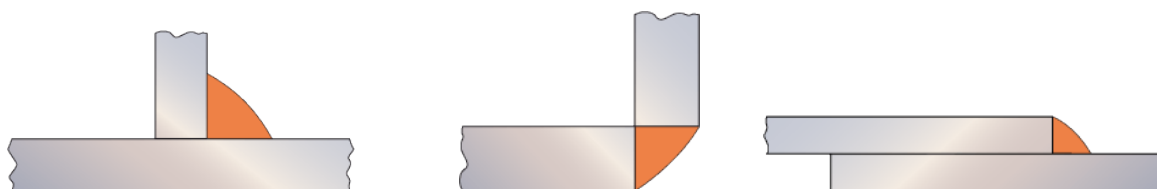
Figura 22 – Solda de filete de junta T, solda de filete de junta de canto e solda de filete de junta de lapela. Fonte: TWI
